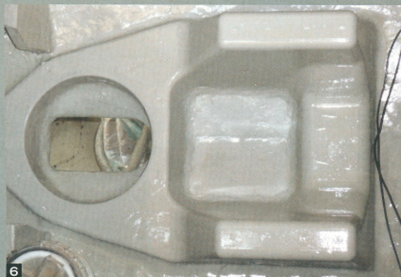
6. Het motorbed is met twee lagen bilge-kwaliteit topcoat afgewerkt.
